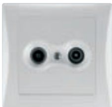
zásuvka anténní (TV+R) koncová 1,5 dB průběžná 7 dB, 14 dB
